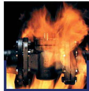
FluoroSeal-Kegelhahn im Fire Safe-Test
